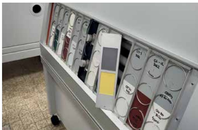
Laborausrüstung zur Prüfung der UV-Beständigkeit
