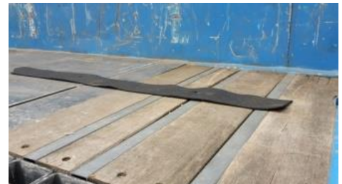
Ladefläche mit Anti-Rutsch Matten auslegen. Vorzugsweise auch zwischen den Paketen.
