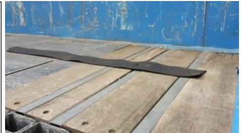
Ladefläche mit Anti-Rutsch Matten auslegen. Vorzugsweise auch zwischen den Paketen.
